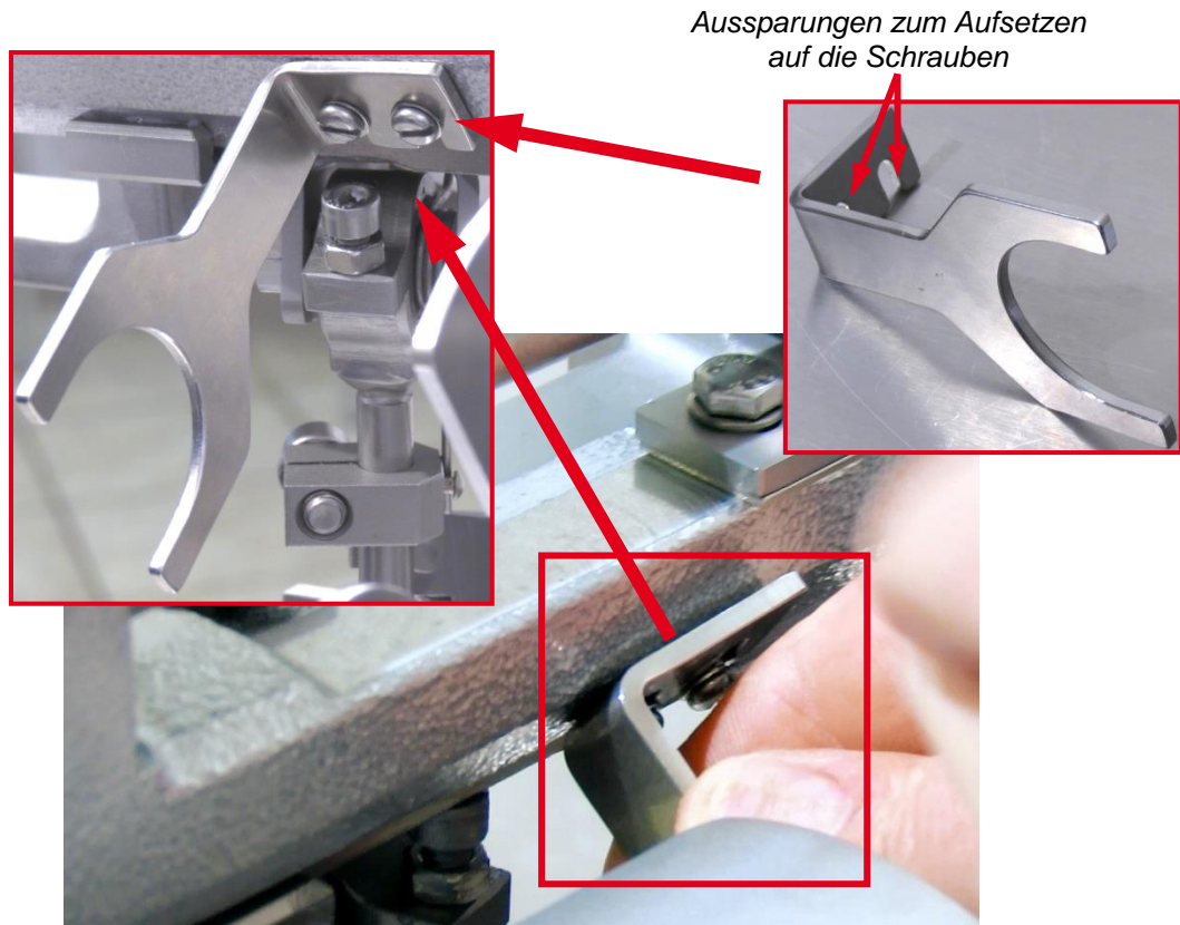
Abb. 38: Abstreifgabel aufsetzen
