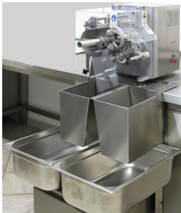
Abb. 62: Maschine mit Trennsystem (Artikel-Nr.: 542752) und Gastronormbehältern (EN 631 1/1)
